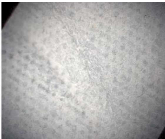
Obrázek 12 – Vzorek 2L2 – Dermizax; 10 000 deformačních cyklů; místo lomu; rubní strana; SM
