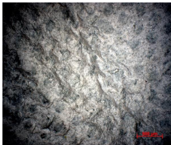
Obrázek 13 - Vzorek 2L2 – Dermizax; 10 000 deformačních cyklů; místo lomu; rubní strana; SM
