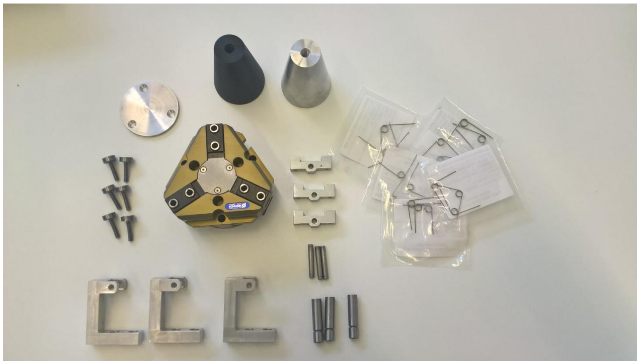
Obrázek 7: Jednotlivé části úchopného systému před montáží
