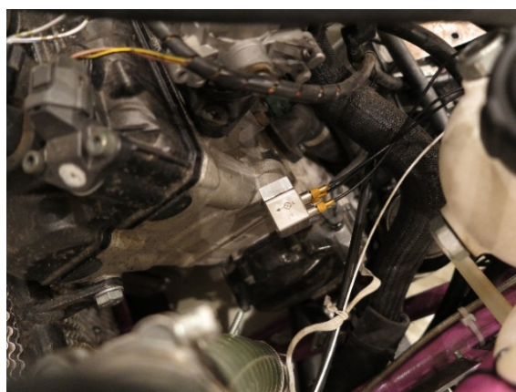
Obr. 10 Akcelerometr na motoru
