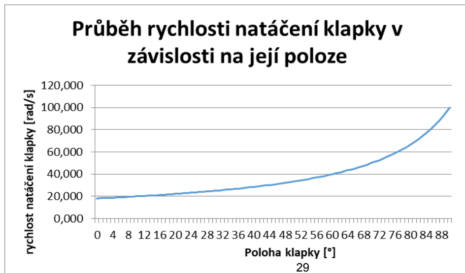
Graf 1: Průběh rychlosti natáčení klapky v závislosti na její poloze (POZN: Pro referenci jsem zvolil rychlost odvíjení lanka 1m/s. Reálně však tuto rychlost je zbytečné kvantifikovat, jedná se tedy primárně o ukázkou průběhu).
