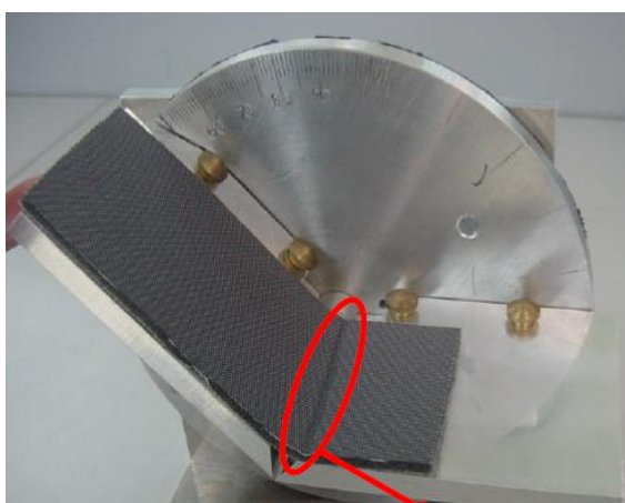
Obrázek 1. Lom přes celou šíři zkušební vzorku [1]
