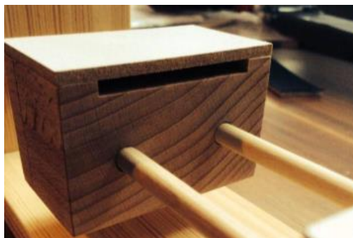
Obrázek 5. Upevnění materiálu v dřevěné čelisti
