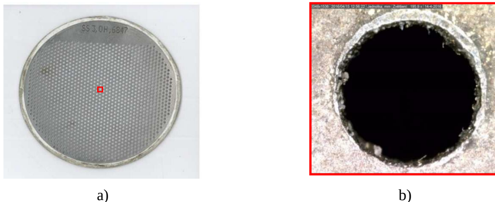
Obr. 3 Kontrolní sítko velikost ss3 H nasnímané z mikroskopu a) nasnímané celé sítko, b) nasnímaný otvor sítko (zvětšení 165,9x).
