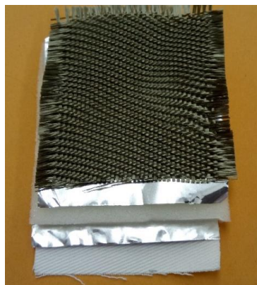
Obrázek 1: Struktura vícevrstvé textilie.
