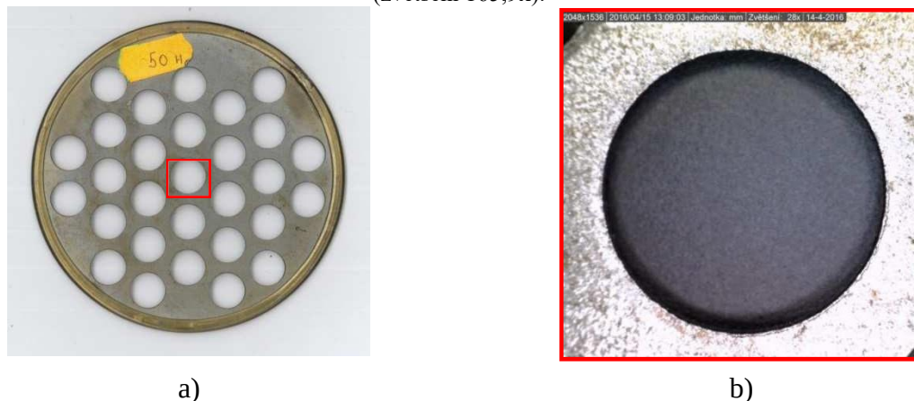
Obr. 4 Kontrolní sítko velikost ss50 H nasnímané z mikroskopu a) nasnímané celé sítko, b) nasnímaný otvor sítko (zvětšení 28x).
