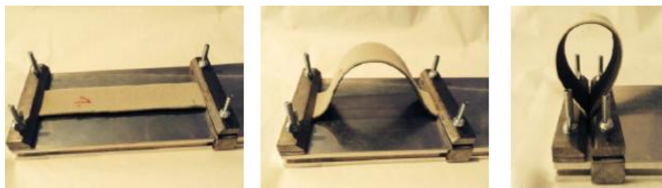
Obrázek 2. Tvorba smyčky: a) počáteční poloha, b) neúplná smyčka, c) konečný tvar
