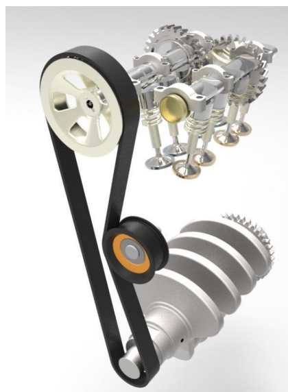
Obrázek 15: Sestava rozvodů motoru
