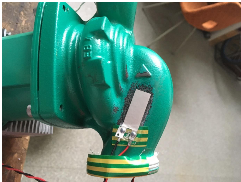
Obrázek 4 Nalepení PVDF filmu na vstupu do čerpadla
