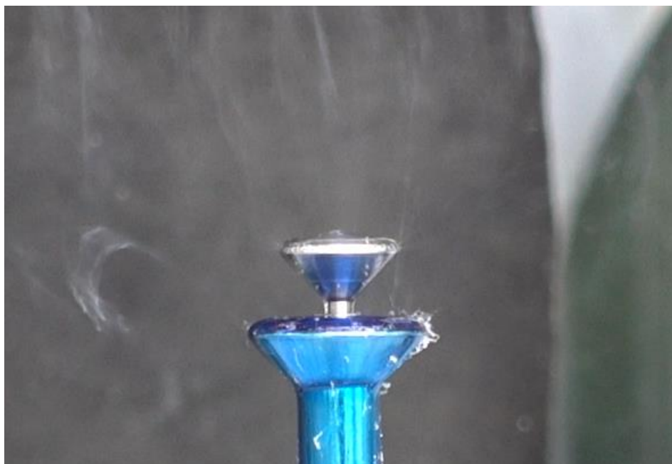
Obr. 7 Zvlákňování s polymerními roztoky PVB (na horní hlavě) a PVA (na spodní hlavě)
