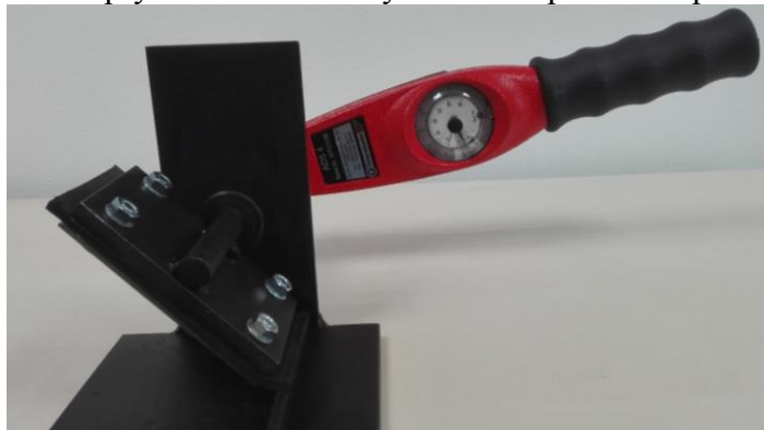
Obr. 11– Měření odporového momentu pryže [vlastní]
