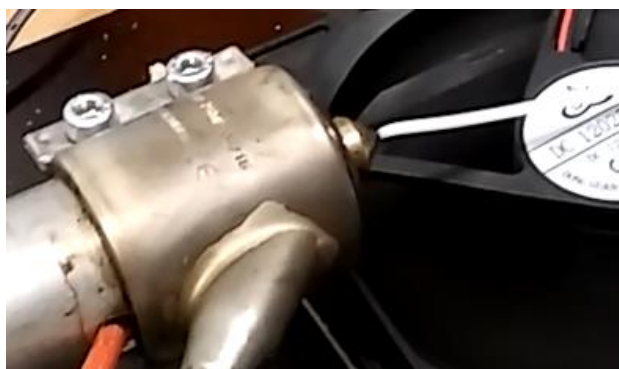
Obrázek 18: Extruze vlákna s průmyslovou tryskou o průměru 1,5 mm
