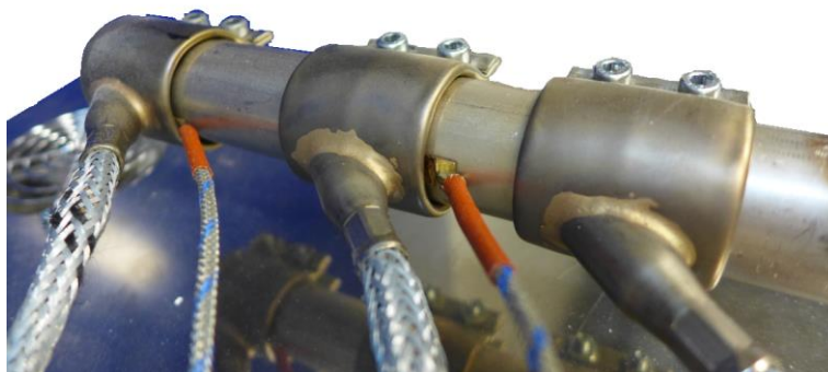
Obrázek 16: Montáž topného tělesa s termočlánkem
