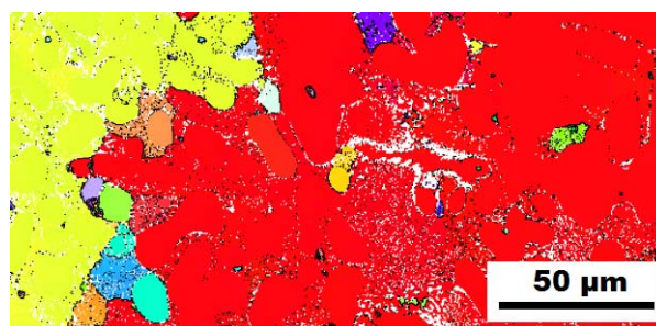
Obrázek 15: EBSD IPF X mapa vzorku FA5Nb as cast.
