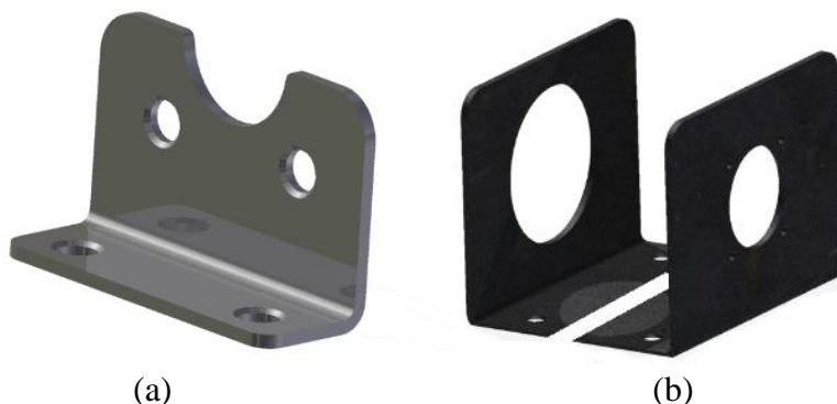
Obrázek 9: (a) Podpěra extruzní komory, (b) Podpěra převodovky a motoru
