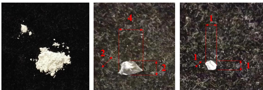
Obr. 6.: a) prach, b) jemná střepáž, c) prachová střepáž
