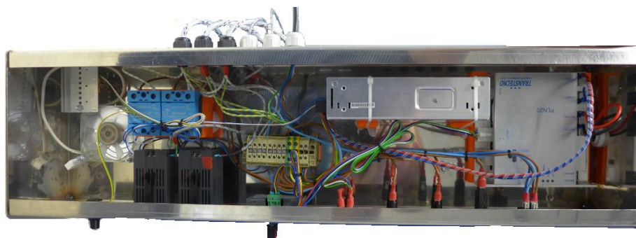
Obr. č. 13: Elektrické a ovládací komponenty uvnitř základny extruderu
