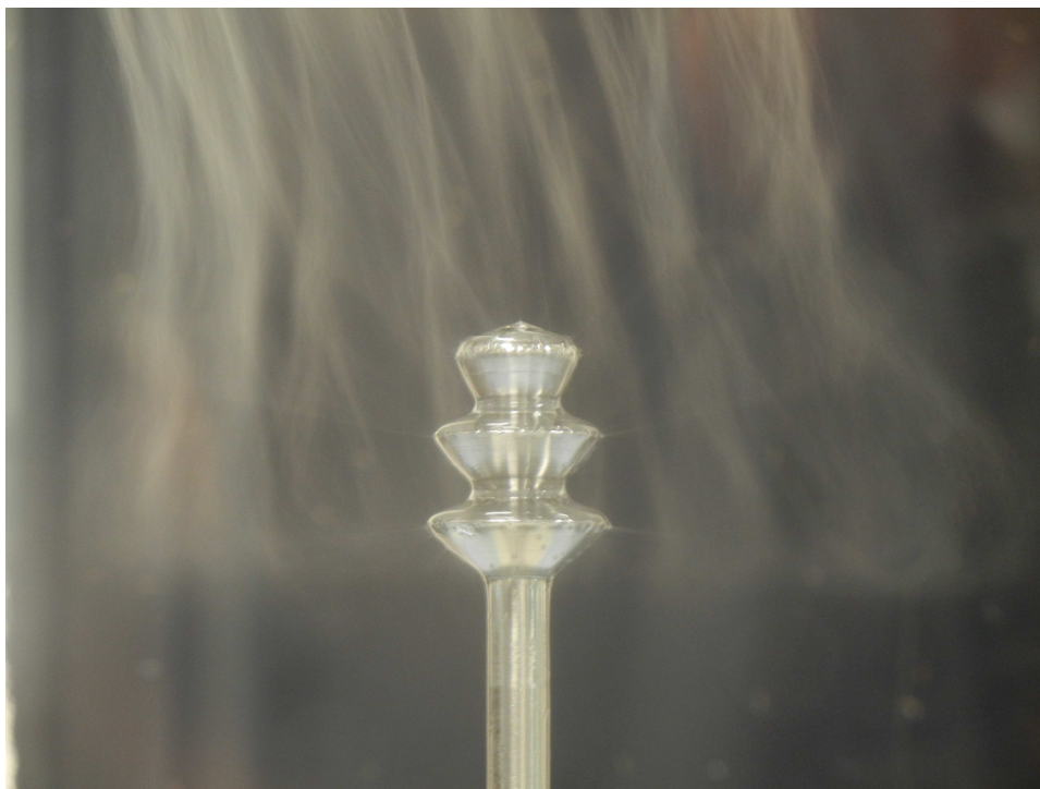
obr.4.2 Záznam zvlákňování na stromečkové elektrodě, napětí 30kV, produktivita 2,95 \pm 0,1 ml/min
