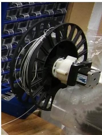
Obrázek 12: Naviják vlákna s cívkou
