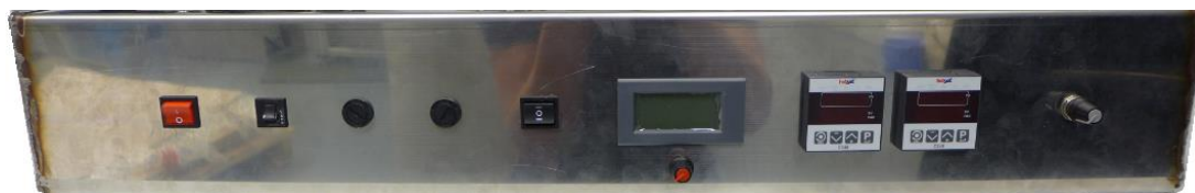
Obr. č. 14: Ovládací komponenty na boku základny extruderu
