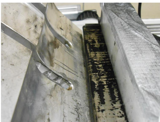
Obrázek 2: Nerovnoměrné dávkování aktivního uhlí
