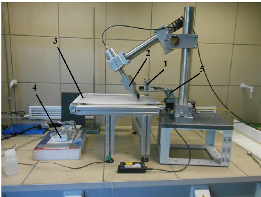
Obrázek 1: Laboratorní přístroj pro výrobu nanovlákněných filtrů. Přístroj se skládá z: 1) Dávkovací silo aktivního uhlí 2) Sonotroda 3) Dopravník s vyráběným filtrem 4) Strunný váleček ve vaničce s polymerem 5) Vibrační zařízení (dávkování aktivního uhlí)
