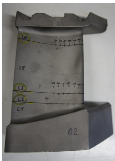
Obr. 4, 5, 6 Vzorky lopatek plynových turbín zhotovených z žárovevných slitin niklu
