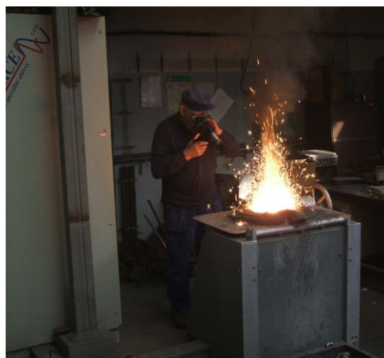
Obrázek 1: Měření teploty optickým pyrometrem v indukční peci.
