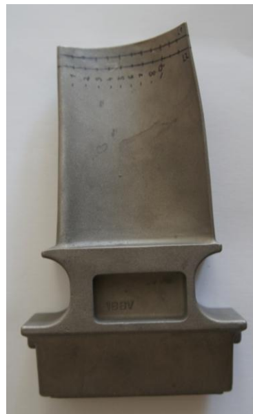
Obr. 4, 5, 6 Vzorky lopatek plynových turbín zhotovených z žárovevných slitin niklu
