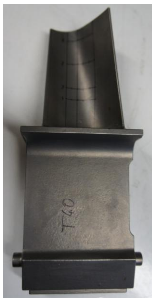
Obr. 4, 5, 6 Vzorky lopatek plynových turbín zhotovených z žárovevných slitin niklu
