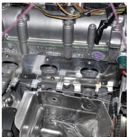
Obr. 4: Pohled na termočlánky upevněné pomocí fixačních přípravků svěrným spojením s tenkostěnnými trubičkami ze strany výfuku. Tenkostěnné trubičky ze strany výfuku jsou vedeny přes kanály s chladicí kapalinou. Tyto trubičky jsou do předvrtaných děr vlepeny. Takto upravená hlava válců motoru prošla zkouškou těsnosti. Vlevo je zobrazen reálný stav na stanovišti, vpravo 3D model.
