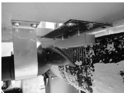
Obrázek 4: Princip nepřetržitého procesu elektrovlákňování
