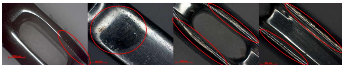
Obr. 3: Mechanické poškození jehel z výroby.
