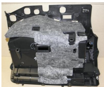
Obr. 7 Pohled na díl ze spodní strany (tam, kde probíhá rozvaření vlastních pinů)
