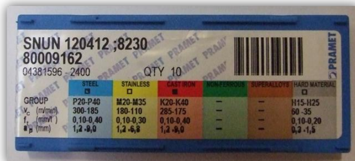
Obr. 3 Povlakované VBD SK 8230 od firmy Pramet
