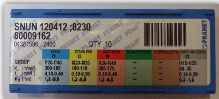
Obr. 3 Povolávané VBD SK 8230 od firmy Pramet
