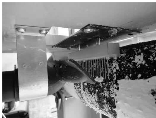
Obrázek 4: Princip nepřetržitého procesu elektrovlákňování
